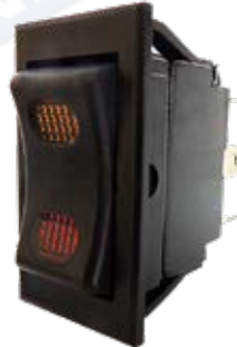
SWITCH RECTANGULAR DE TRES PASES Y 4 CONTACTOS ILUMINADO ROJO Y NARANJA 24V
